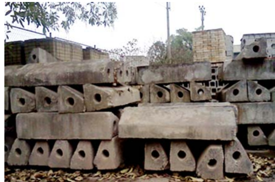
Sản phẩm viên bê tông bó vữa sử dụng cốt liệu tái chế
